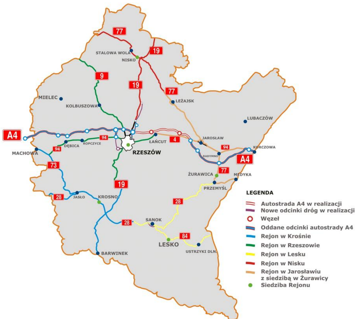
Rysunek 43. Sieć dróg zarządzanych przez rzeszowski oddział Generalnej Dyrekcji Dróg Krajowych i Autostrad z podziałem na rejony 96
